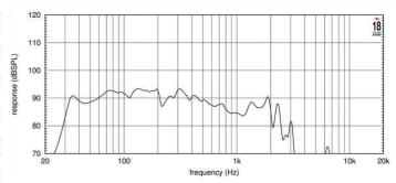
FREQUENCY RESPONSE MADE IN 180 LT. ENCLOSURE TUNED AT 35 Hz IN FREE FIELD (4n) ENVIRONMENT. ENCLOSURE CLOSES THE REAR OF THE DRIVER
